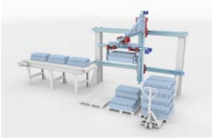
Très innovant, ce système est idéalement adapté aux applications industrielles. En effet, cette configuration permet une très nette réduction des coûts puisqu'elle ne nécessite qu'une seule unité linéaire et une seule motorisation, là où habituellement deux sont nécessaires. La technologie Speedy Rail (galets revêtus plastique roulant directement sur le profilé) ne requiert aucune lubrification et est très résistante aux contaminants.
