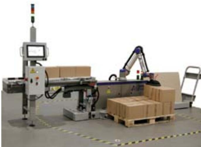
Cette plate-forme automatisée garantit un niveau maximal de protection pour les opérateurs et une prise en charge parfaite des produits avec une préhension qui s'effectue toujours au-dessus du convoyeur ou du poste de palettes et un préhenseur en mousse pour un contact plus doux le cas échéant et pour prévenir les blessures lors des interventions de maintenance.
