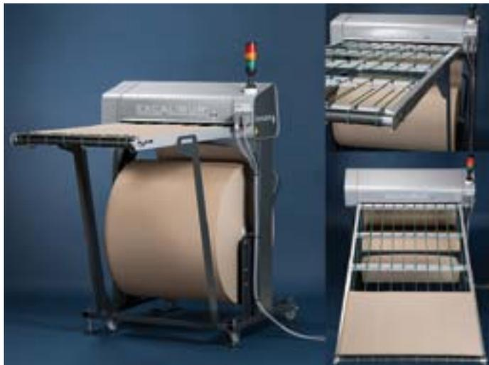
Excalibur permettait jusqu'ici de gérer en simultané la production d'intercalaires de dimensions 800 x 1200 mm et 1000 x 1200 mm. Il pourra désormais, grâce à sa nouvelle option baptisée 'refente', assurer en plus la production de deux intercalaires pour demi-palettes (600 x 800 mm et 600 x 1000 mm) ou de quatre intercalaires pour quart-de-palettes (400 x 600 mm), à partir d'une seule et même bobine.
